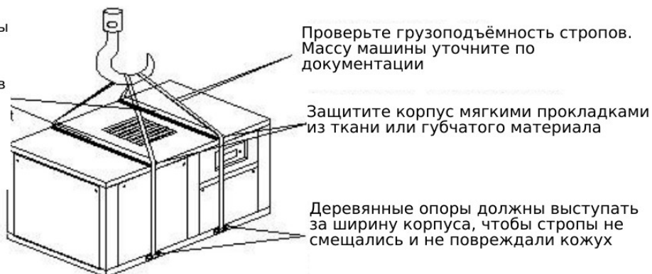
Рисунок 2 — Перемещение погрузчиком и подъём краном.
